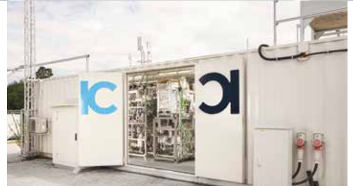
Power to Liquid im Container: Die neue Kompaktanlage im Energy Lab 2.0 holt sich CO 2 direkt aus der Luft.
